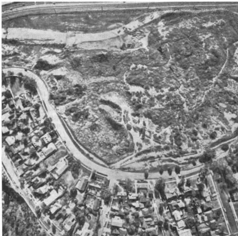
Фото. 4.10. Древний, периодически возобновляющийся оползень. Приморское шоссе 101, Санта-Моника, штат Калифорния. Оползень занимает полукруговую площадь над дорогой, идущей по его периметру. Новая дорога видна в верхней части снимка.
