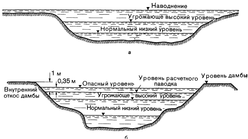
Фиг. 7.8. Различные уровни воды при паводке на не огражденных ( верхняя схема ) и огражденных дамбами ( нижняя схема ) водотоках.
